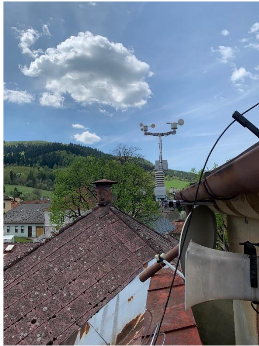
Snímač rýchlosti vetra (anemometer)
